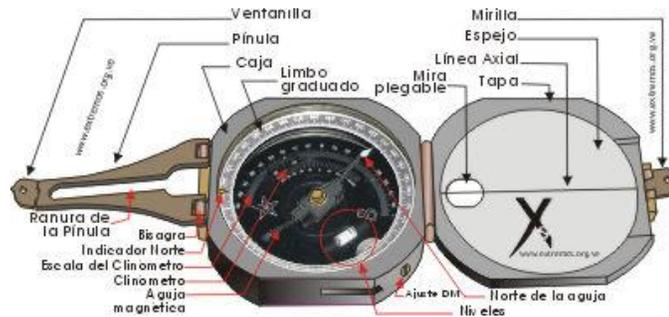
Ilustración 2.- Partes de una brújula
