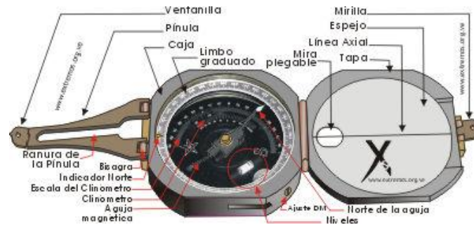
Ilustración 2.- Partes de una brújula
